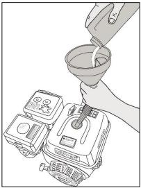
Рис. 13. Заливка бензина
