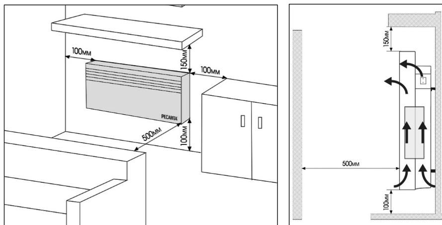
Рис. 3. Расположение конвектора.
