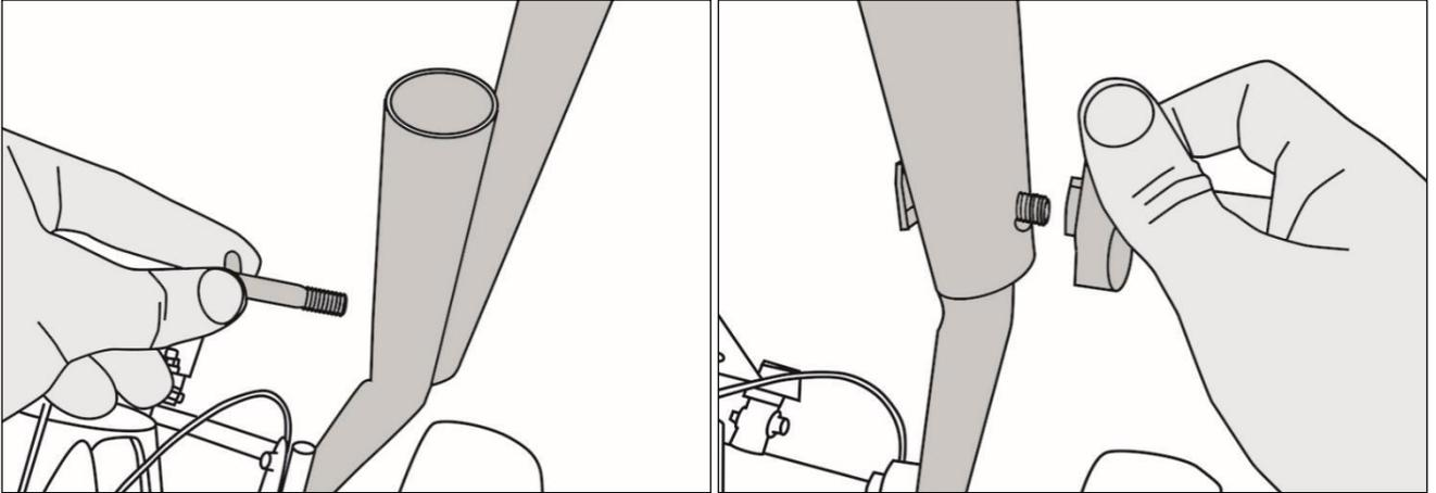
Рис. 5. Закрепление верхней рукоятки управления
