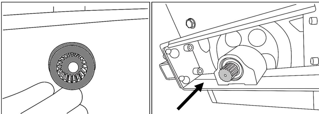
Рис. 14. Соединение шлицов модуля и подметальной машины
