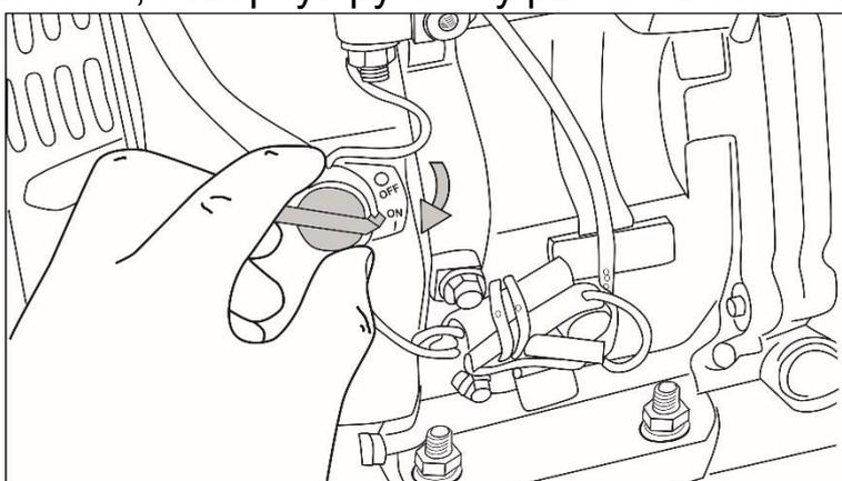
Рис. 20. Включение зажигания
