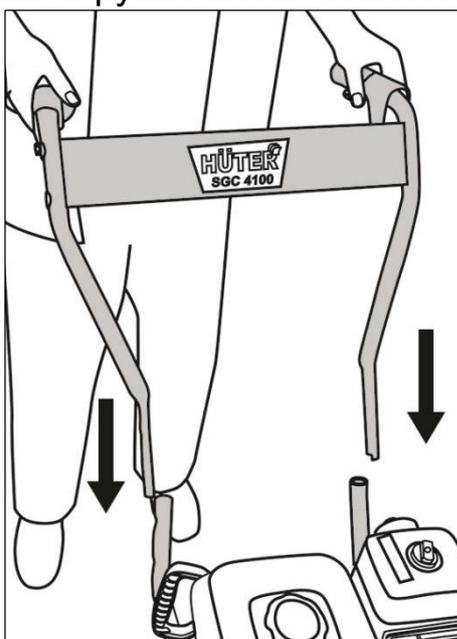
Рис. 4. Установка верхней рукоятки управления
