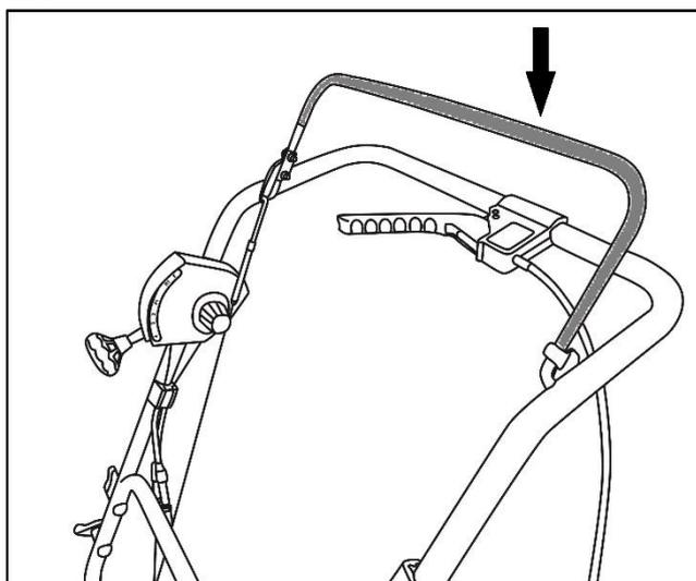
Рис. 23. Нажатие рычага привода колес
